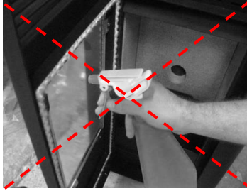
Figura 57 - Limpeza incorreta do vidro
