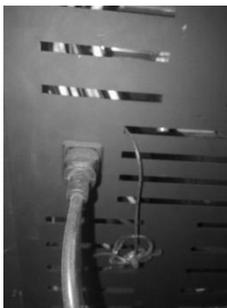
**Figura 9 – sonda de temperatura ambiente**
