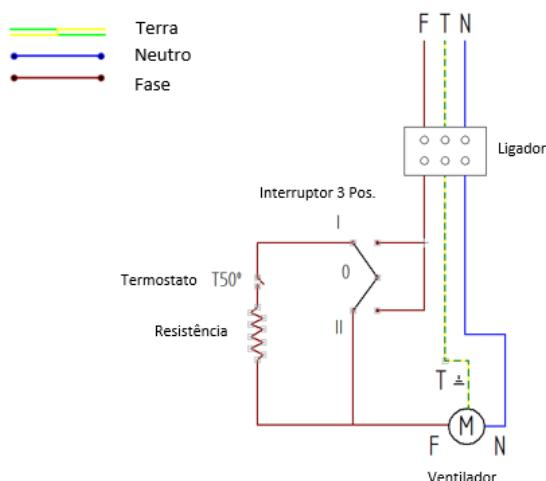
Figura 10 - Esquema Elétrico
