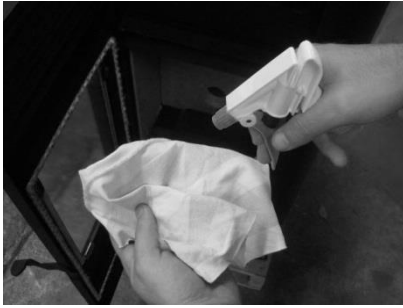
Figura 27 – Limpeza do vidro: a) Aplicar líquido no pano; b) Limpar o vidro com o pano
