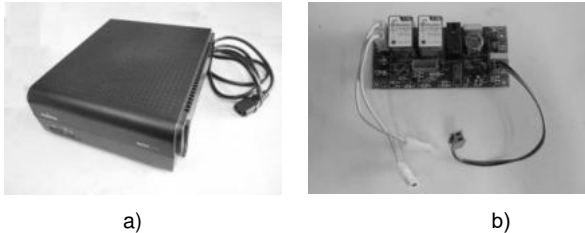
Figura 100 - a) esempio UPS (non incluso nel kit); b) componenti del kit gruppo di continuità
