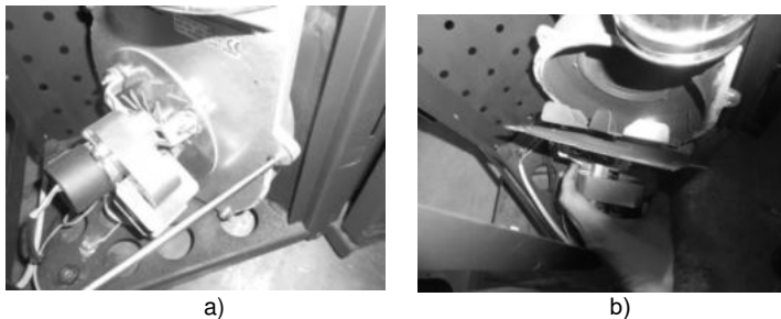
Figura 93 - a) Rimuovere i bulloni; b) Rimuovere estrattore
