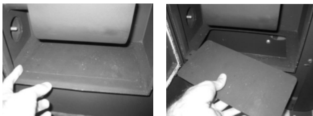
Figura 125 - limpeza do interior da salamandra
