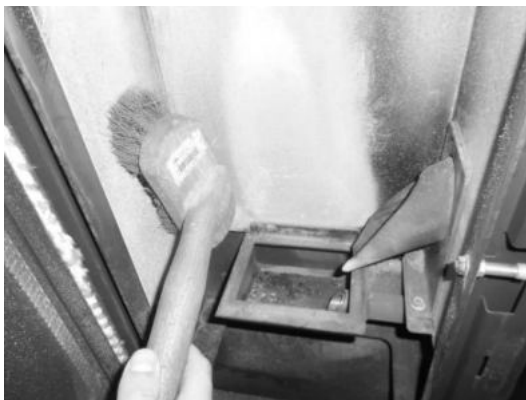
Figura 81 - Pulizia della vermiculite
