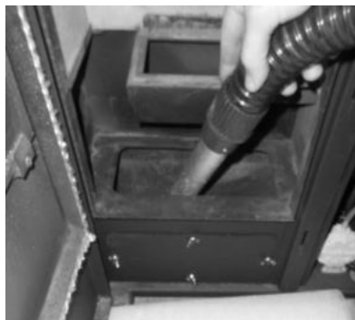
Figura 85 - Pulizia dell'interno della stufa
