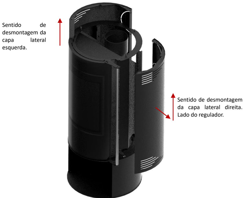
Figura 12 - Desmontagem das capas laterais no equipamento
