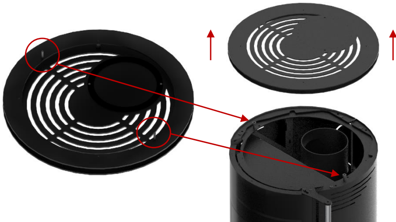
Figura 10 - Desmontagem do tampo no equipamento
