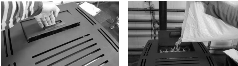
Figura 18 - Abastecimento do depósito de pellets
